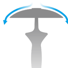
Гладкая поверхность не позволяет задерживаться снегу и грязи
