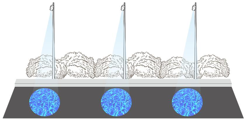
Проекционный светильник для создания разнообразных эффектов на пешеходных дорожках.
